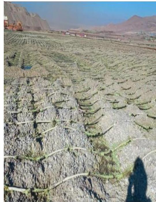
Al detectarse taponamientos, parte del equipo realiza una maniobra manual por línea (llamada “flashing”) que busca destaparlos. La forma en que se trata de desbloquear no permite una confirmación fehaciente de un resultado óptimo, sino hasta una siguiente medición manual y muestral.
